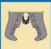
Grindă în I forfecată de lamele de tăiere
